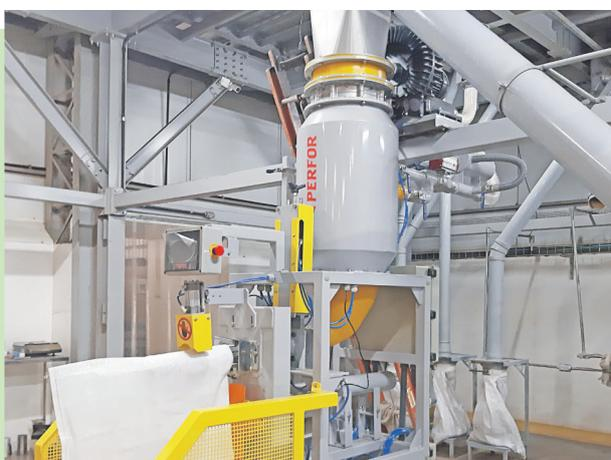
Aquisição e instalação de máquina embaladora semi automática com capacidade de ensacamento de 8 toneladas por hora.
